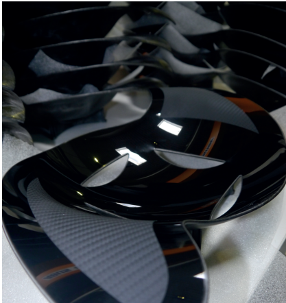
Dekoschalen, hergestellt durch eine Verfahrenskombination aus variothermem Schaumspritzgießen und Negativprägen
